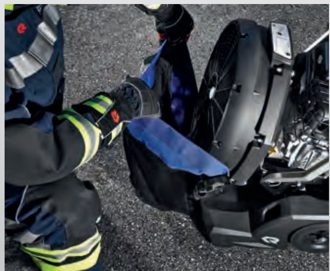
Schaumnetz an der Ventilatoreinheit montieren.
