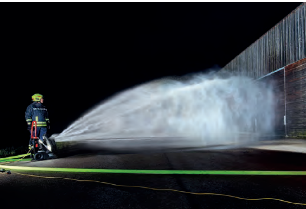
Wurfweiten bis zu 20 m sind möglich.
