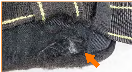
Acolchado muy desgastado. El desgaste de partes no estructurales no debe ser subestimado porque puede ser un indicador general del estado de desgaste del equipo.
