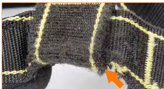
Fettuccia estremamente usurata in prossimità degli incroci di fettuccia.
