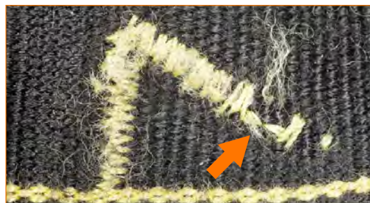
Sicherheitsnaht mit durchtrennten Fäden.
