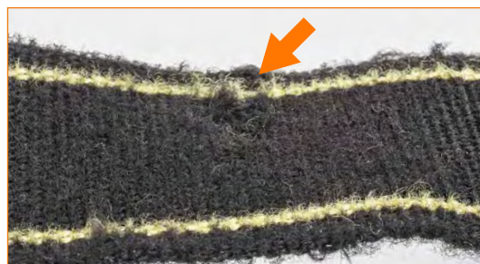
Cinta desgastada con evidente salida de hilachas.
