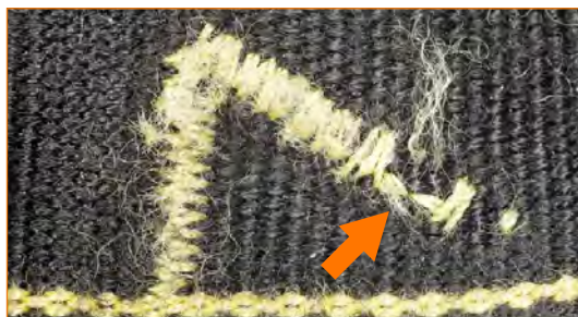
Costuras de seguridad con hilos cortados.
