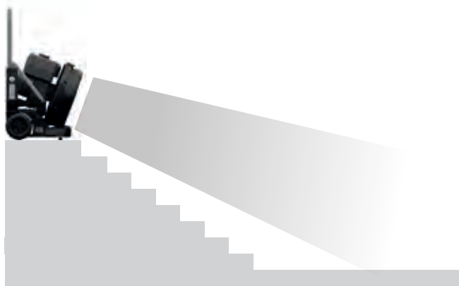
Wejście do piwnicy (- 20° lub -6°)
