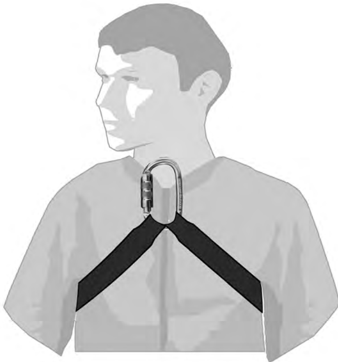
Bild 10 Rettungsschleife Typ A
