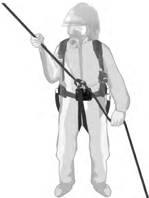
Bild 13 Verwendung von Rettungssitz/Rettungsschlaufe Typ B
