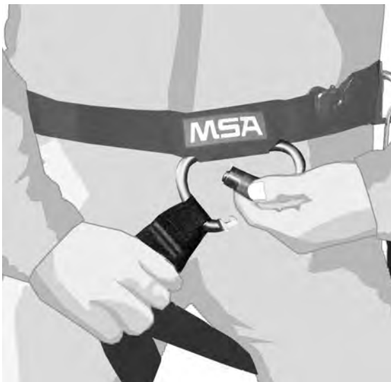
Bild 12 Verbinden der roten genähten Schlaufe
