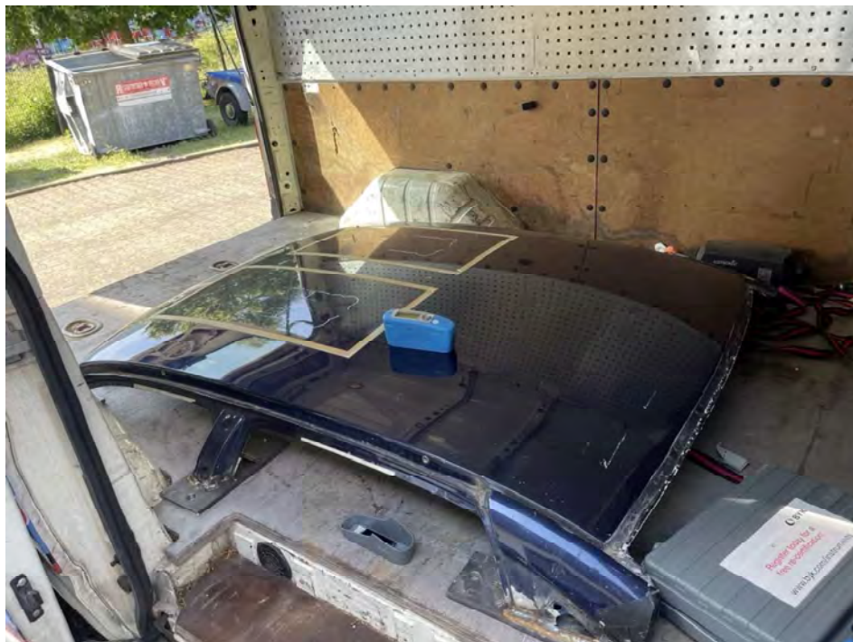
Abbildung A5.3 – Messung Glanzfaktor Overview
