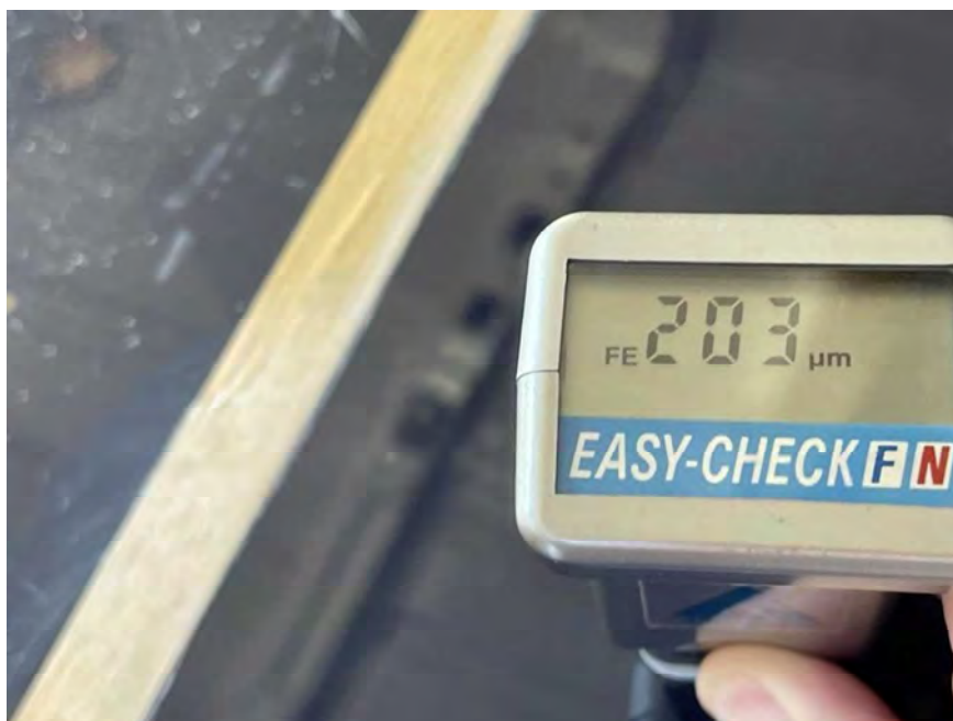
Abbildung A5.2 – Messung Lackdicke Detail
