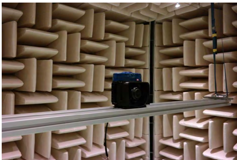
Bild 3: Messanordnung im reflexionsarmen Halbfreiefeldmessraum
