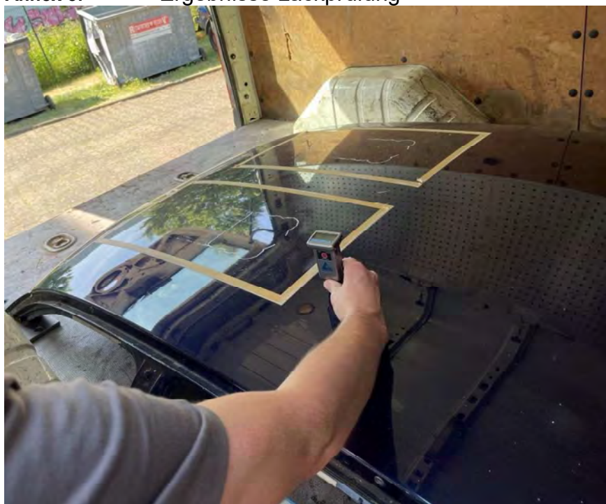
Abbildung A5.1 – Messung Lackdicke Overview
