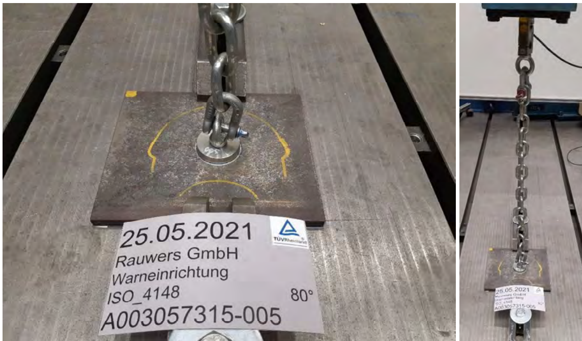
Abbildung A2.4 – Prüfaufbau Prüfung 80°C
