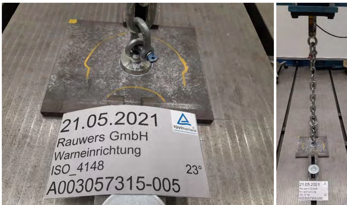
Abbildung A2.2 – Prüfaufbau Prüfung 23°C
