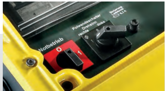
Polwendeschalter und Notbetriebsschalter
