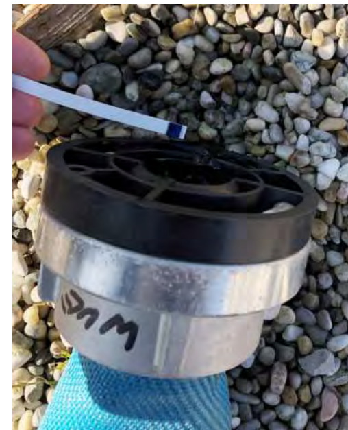
Nachweis des Desinfektionsmittels am Ende des Schlauchs
