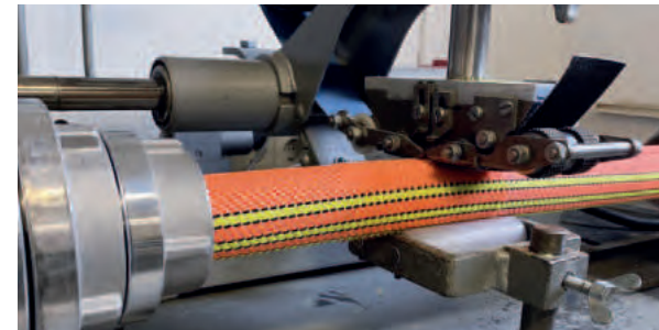
Links: Abriebtest Oben: Schlauch nach Abrieb
