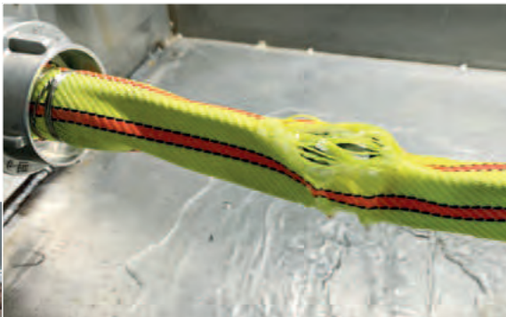
Ohne Abrieb geplatzter Feuerlöschschlauch
