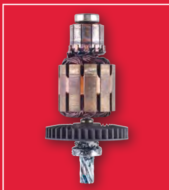
Verbrannter Motor aufgrund von Überlastung
