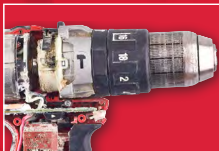
Beispiel für übermäßigen Verschleiß
