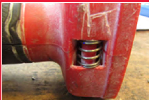
Außen angebrachte Feder, die ein unbefugtes Öffnen des Werkzeugs verhindert.
