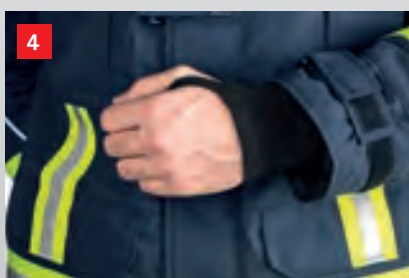
4 Individuelle Weitenanpassung am Ärmelende durch eine Klettverstelllasche, Ärmelabschluss mit neuartigem NOMEX Strickbund und Daumenloch
