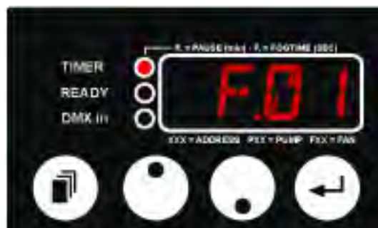
Abbildung 6: Einstellen der Nebelzeit in Sekunden (1 - 99)
