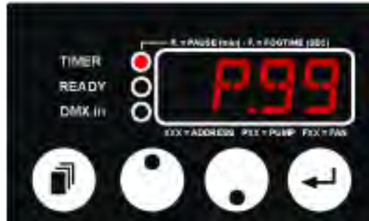
Abbildung 5: Einstellen der Pausenzeit in Minuten (0,1 - 99)
