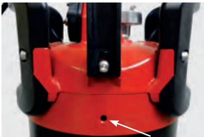
Kontrollöffnung für Gleitringdichtung
