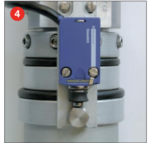
Standard angebauter und verkabelter Mastausfahrwarnschalter
