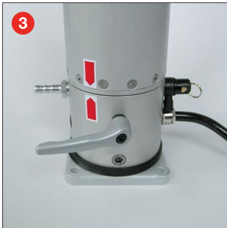
3 360° drehbare Kardan-Basis mit Luftanschluss, Sicherheitsventil für manuelle Entwässerung und Klemmsystem
