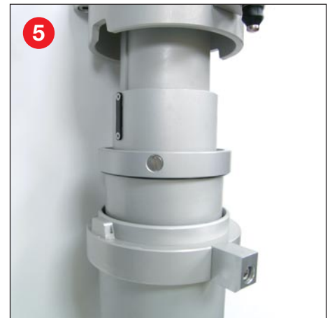
5 Abdeckung zum Schutz der nutengeführten Mastrohre
