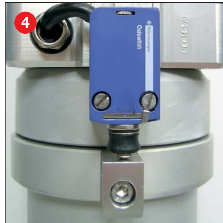
4 Standard angebauter und verkabelter Mastausfahrwarnschalter
