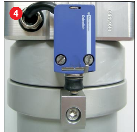
4 Standard angebauter und verkabelter Mastausfahrwarnschalter
