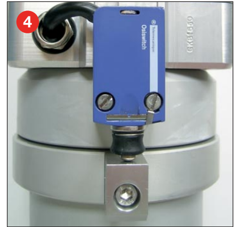
4 Standard angebauter und verkabelter Mastausfahrwarnschalter
