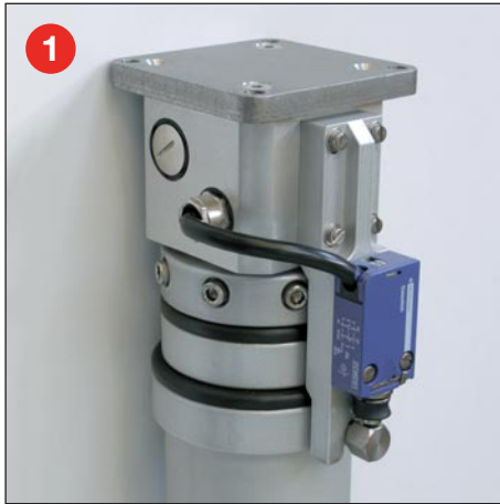
Mastkopf Montage mit 1 x PG9, 1 x PG11, 1 x PG13,5 Kabelverschraubungen und 8 mm Flanschplatte ausgestattet mit nutengeführten Mastrohren
